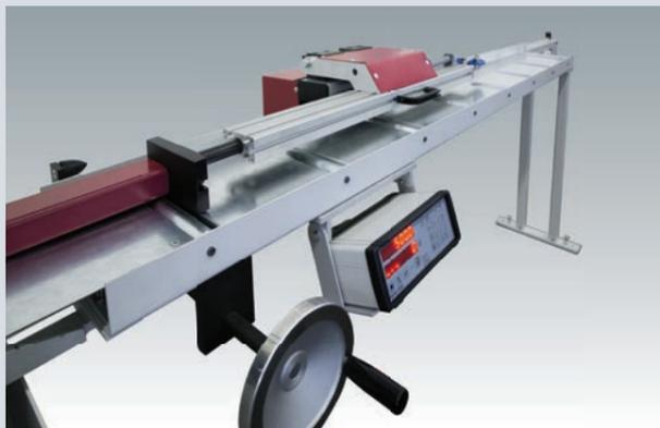
**Elektronisches Längenmesssystem MHK**
