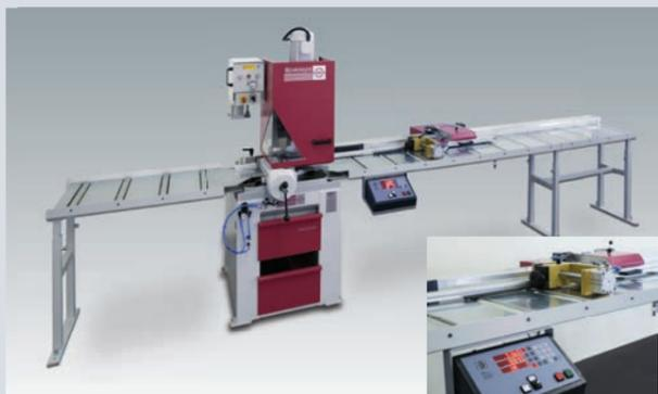
**Elektronisches Längenmesssystem mit Nachschubzange ELA-P**
